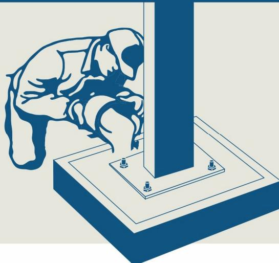
**LEMAX Non-Shrink Grout LM-G650** là vữa kỹ thuật dạng bột đã được trộn sẵn, chỉ cần pha thêm với nước sạch theo đúng tỷ lệ sẽ được hỗn hợp vữa đồng nhất cho ứng dụng rót hoặc bơm, với nhiều ưu điểm nổi bật:
